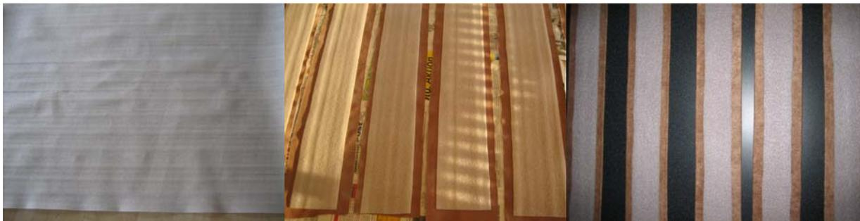
Nun die Isolationsstreifen schön zentriert auf die entsprechenden Stoffstreifen kleben. Dabei entstehen links und rechts der Isolationsstreifen Stoffnahtzugaben, welche in einem zweiten Schritt auf die Rückseite der Isolationsstreifen geklebt werden.
